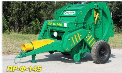
Исполнение пресс-подборщика ПР-Ф-145 оснащен системой автоматизированного контроля (САК), позволяющей наблюдать за работой механизмов пресс-подборщика и дистанционно управлять технологическим процессом.
